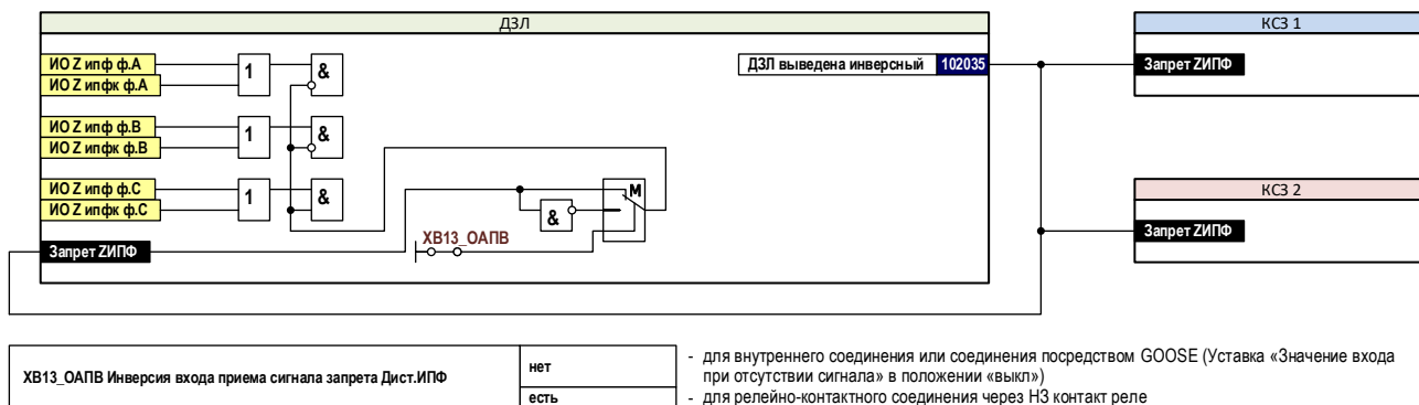
Рисунок Л.3 Схема подключения шкафов ДЗЛ и КСЗ (в т.ч. с логикой ШЭТ)
