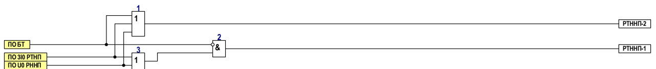
Рисунок 27.1 – Функциональная схема логической части узла ОВП
